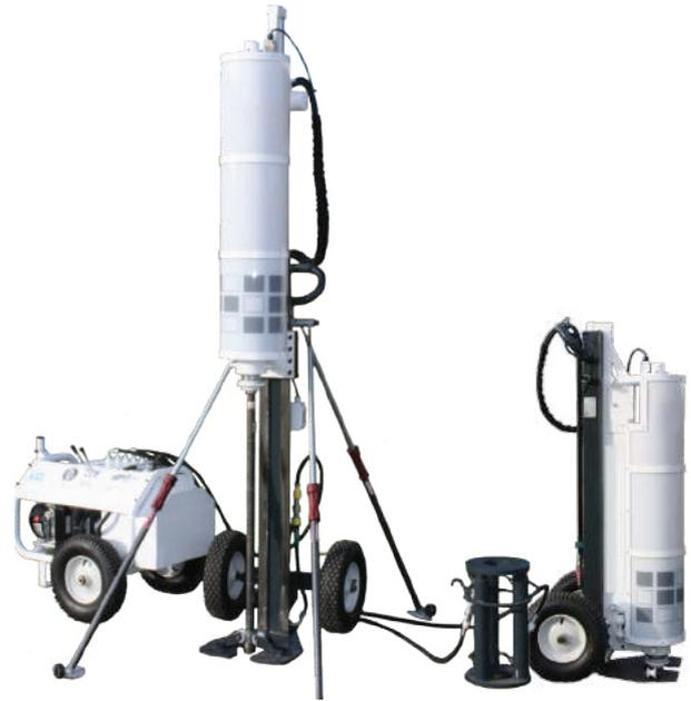
Pénétrromètre Pro03 déployé et fermé
